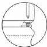
Б) Поместите массажный блок перед креслом. Плотно подсоедините воздушную трубку массажного блока для ног к соответствующему соплу на корпусе. Плотно вставьте разъемы шнура питания в розетку на корпусе кресла, язычок разъема шнура питания должен быть направлен вверх. Убедитесь, что воздушная трубка и провод не скручены между собой и не пережаты. Проверьте качество всех соединений.
