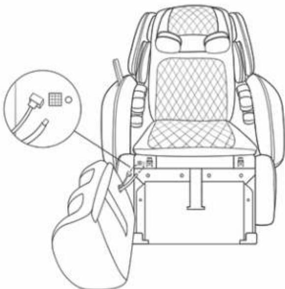
В) Откройте фиксатор оси, аккуратно поднимите массажный блок для ног и совместите ось с кронштейном. Закройте фиксатор оси, установите на место два винта и закрутите их.
